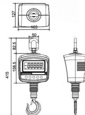
Ce **dynamomètre compact** vous permettra de contrôler son fonctionnement à distance grâce à sa **télécommande** et de figer une mesure avec sa fonction "**Hold**" en toute sécurité, avec son linguet et sa manille tournante.
